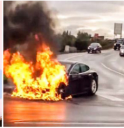
2013: Batteriebrand eines Tesla Model S ausgelöst durch Kollision mit einem harten Metallgegenstand. 4
