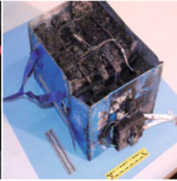
2013: Thermal Runaways bei Energieversorgungssystem von Boeing 787 Dreamliner. Viermal Probleme, zweimal brannte es. 3
