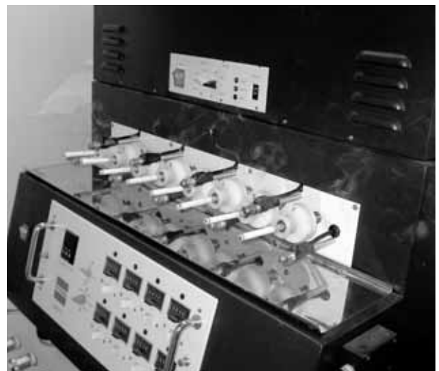
Abb. 6.15 Die sogenannte «Abrauchmaschine» simuliert das Rauchen und analysiert das Kondensat
