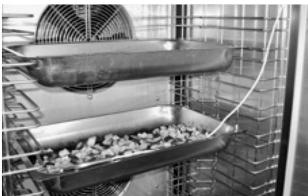
Abb. 4.6.1 Unhygienischer und falscher Einsatz des Kerntemperaturfühlers samt Kabel im Schockkühler.
